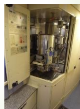
各車両にあるサモワール式湯沸かし器
