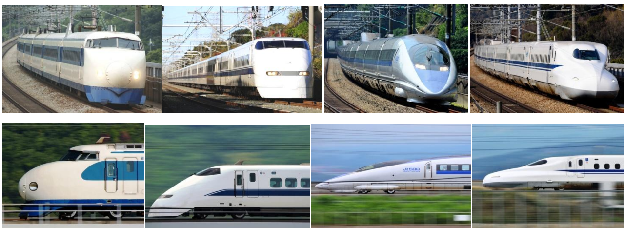
Слева направо – фронтальный (верхний ряд) и боковой (нижний) вид синкансэнов линии «Токайдо» по мере их развития – серии «0», «300», «500», «N700»
